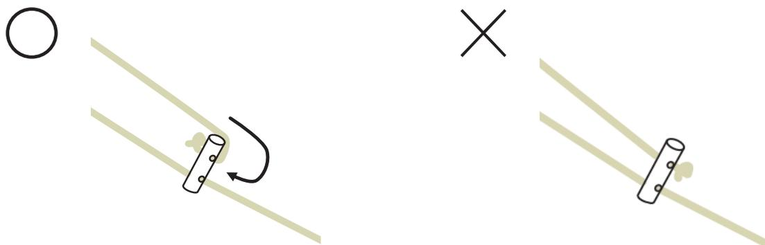
紐を張るための自在が外れてしまった場合は左上の図の様に取り付けます。自在のフレーム側から脚先側へ紐を自在に通し、抜けないように堅結びをしてください。
