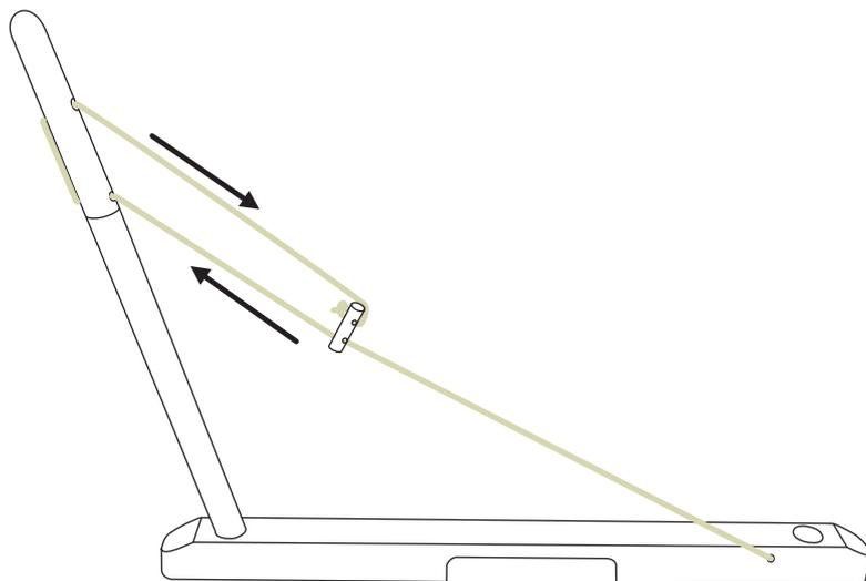
差し込みが完了したら、図のように脚先の穴と紐とフレームが一直線になるように調整してください。その後矢印の向きに紐を引き、紐を張ってください。
